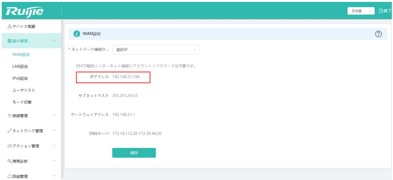
その他の IP アドレス割り当て方式を設定する場合は「ネットワーク接続タイプ」をクリックして選択します。「動的 IP」、「固定 IP」の 2 種類が用意されています。具体的な設定については、2 章 5 節の「ルータモードの設定」をご参照ください。
