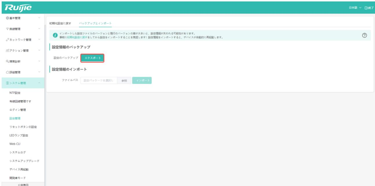
デバイスをシステムリセットした後、以前の設定を同期させたい場合は、「設定管理」->「バックアップとインポート」->「参照」をクリックし、以前にバックアップした設定ファイルを選択します。
