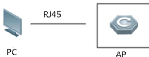
イーサネットケーブル（RJ45）で本製品と管理 PC を接続します。管理 PC につないだイーサネットケーブルを LAN ポートにカチッと音が出るまで差し込みます。
